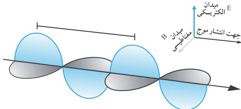
اگر مقدار میدان الکتریکی و یا میدان مغناطیسی را بر حسب جایه‌جایی رسم کنیم شکل زیر را خواهیم داشت: (این شکل در واقع همان مقطعی از شکل بالا می‌باشد، این مقطع می‌تواند هم برای میدان مغناطیسی و هم برای میدان الکتریکی رسم شود).
