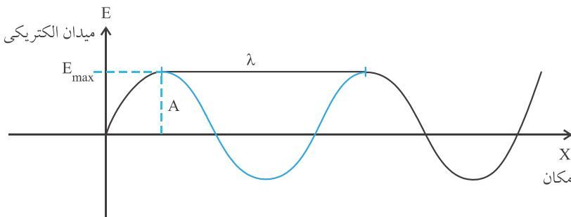
اگر به این شکل دقت کنید، با حرکت در راستای انتشار این موج، مقدار میدان الکتریکی از صفر شروع می‌شود، به یک مقدار  $E_{\text{max}}$  (بیشینه) می‌رسد سپس مقدار آن کاهش می‌یابد و مجدداً این مقدار به صورت متناوب تغییر می‌کند. تغییرات متناوب مقدار میدان الکتریکی و مغناطیسی برای امواج الکترومغناطیس مشابه آنچه در شکل رسم شده است، می‌باشد. با توجه به شکل، به یادآوری برخی مفاهیم موج می‌پردازیم:
