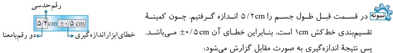
**نکته ۱۲** در گزارش نتیجهٔ یک اندازه‌گیری، باید تعداد اعشار خطای دستگاه و مقدار اندازه‌گیری شده، یکسان باشد. مثلاً اگر کمینهٔ تقسیم‌بندی یک ترازو  $1\text{ kg} \pm 0.5\text{ kg}$  باشد، خطای آن برابر نصف این مقدار یعنی  $0.5\text{ kg} \pm 0.5\text{ kg}$  می‌شود و ما نیز باید گزارش خود را تا صدم کیلوگرم گزارش کنیم:
