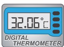
$$\text{نمونه} \quad \text{در دماسنجهای دیجیتال شکل مقابل، که عدد } 32.06^{\circ}\text{C را می‌خواند، دقت دماسنجه برابر } 0.1^{\circ}\text{C} \text{ و خطای } 32.06^{\circ}\text{C} \rightarrow d = 0.1^{\circ}\text{C} \text{ است.}$$
