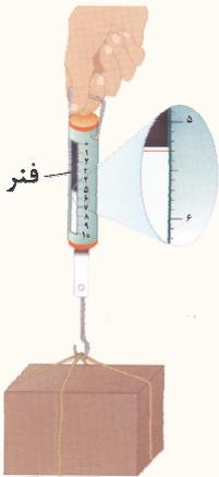
**نکته** وزن یک جسم توسط نیروسنج اندازه‌گیری می‌شود. مقدار کشیدگی فنر درون نیروسنج به اندازه نیرویی بستگی دارد که به نیروسنج وارد می‌شود.
