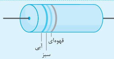
$$R = 6 \quad \downarrow \quad 5 \times 1 = 6 \Omega \quad \text{فوههای (حلقه سوم)} \rightarrow$$
