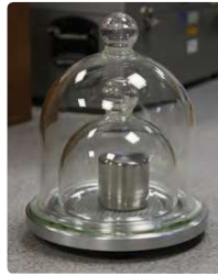
شکل ۱-۷ استاندارد ملی کیلوگرم که نسخه دقیقی از استاندارد بین‌المللی سور فرانسه است. این نمونه، در مرکز اندازه‌شناسی در سازمان ملی استاندارد ایران نگهداری می‌شود.
