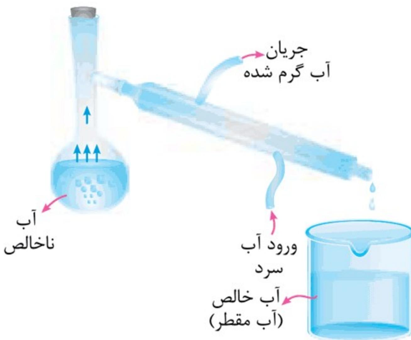
**تقطیر جزء به جزء (Fractional distillation):** به فرایند تقطیر مخلوط چند مایع که نقطه جوش آنها به اندازه کافی از هم متفاوت باشد، گفته می‌شود. طی این فرایند، بخارات هر مایع در دمای جوش خود به مایع تبدیل می‌شود و به این ترتیب، مایع‌های مختلف از یکدیگر تفکیک می‌شوند. جداسازی اجزای مختلف تشکیل‌دهنده نفت خام از یکدیگر، بهترین مثال برای انجام تقطیر جزء به جزء است که در ستون تقطیر جزء به جزء ویژه‌ای در صنعت نفت انجام می‌شود.
